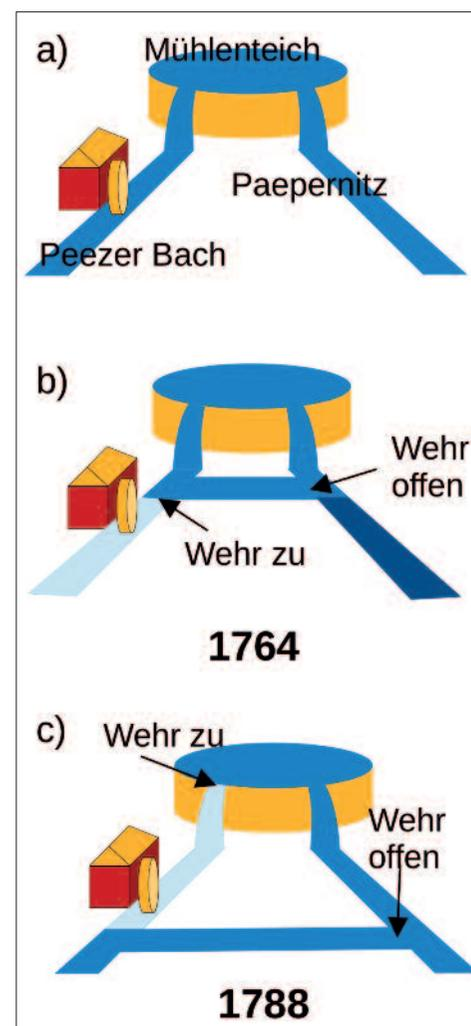
Zweck das Wasser über die Paepernitz an der Mühle vorbeileiten. Der Nordarm fiel dann trocken und das Mühlrad stand still (s. Grafik).
